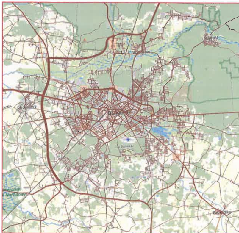
Rysunek 7.18. Wydruk z modelu ruchu obrazujący wyprowadzenie ruchu tranzytowego z centrum
